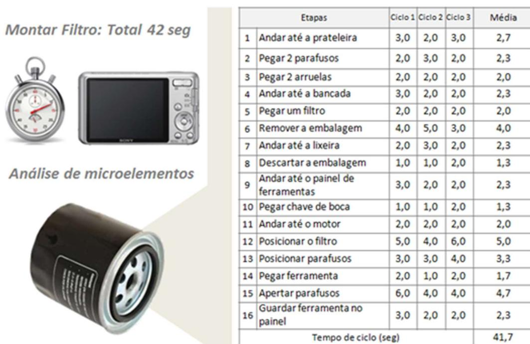
Figura 7 - Detalhamento de uma operação pelo método de microelementos.
