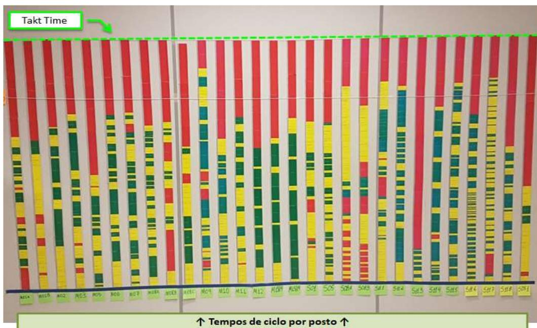
Figura 5 - Relação entre tempos de Ciclo e Takt Time em uma linha de montagem tracionada por esteira.
