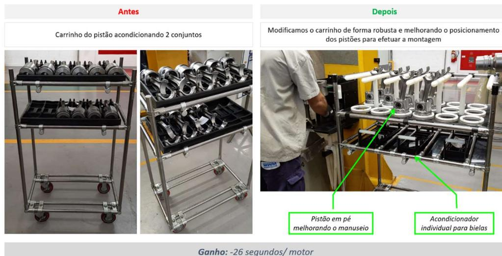
Figura 14 - Ideia para eliminação de desperdício evidente e redução do desperdício oculto.
